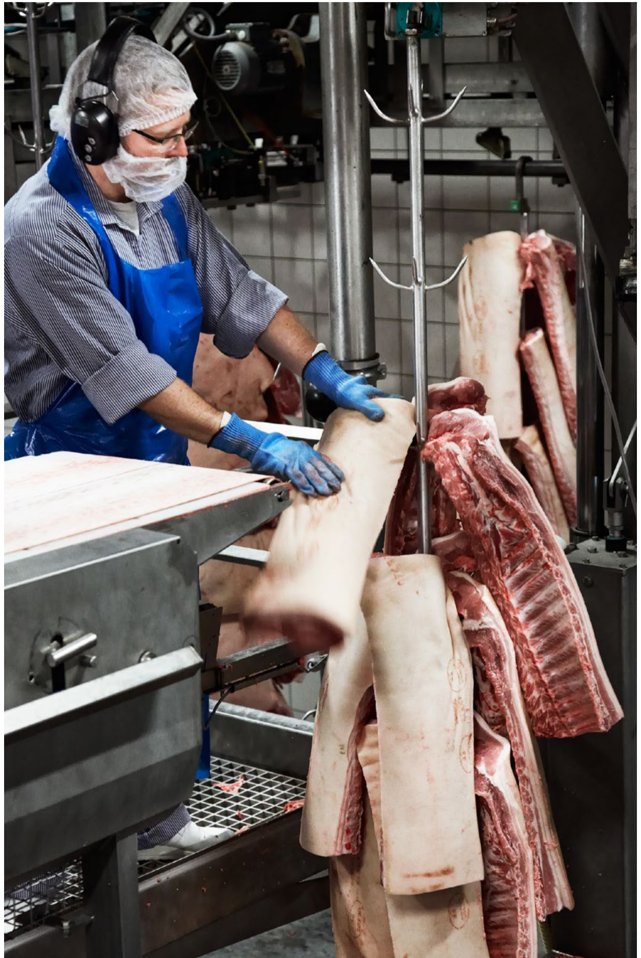
Før krævede det mange løft og vrid for at hænge kød på juletræerne. Nu drejer de rundt og hejses automatisk op og ned, så medarbejderne skånes. Foto: Claus Petersen.
